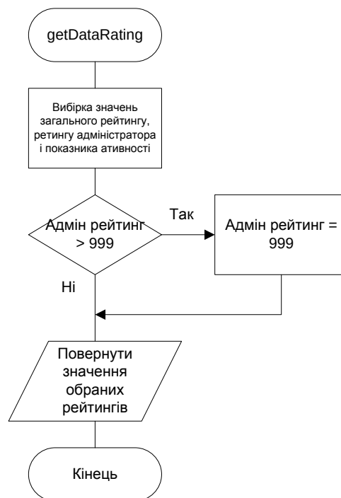
Рис. 3.3. Блок схема методу getDataRating
