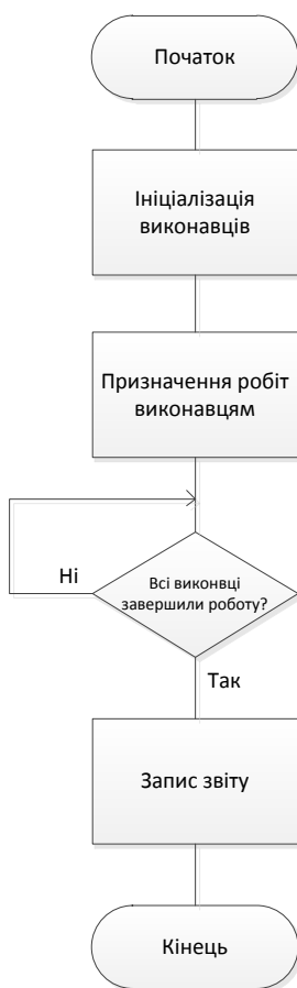
Рис.3.5. Блок схема алгоритму роботи скрипта диригента
