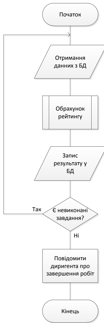
Рис.3.6. Блок схема алгоритму роботи виконавця
