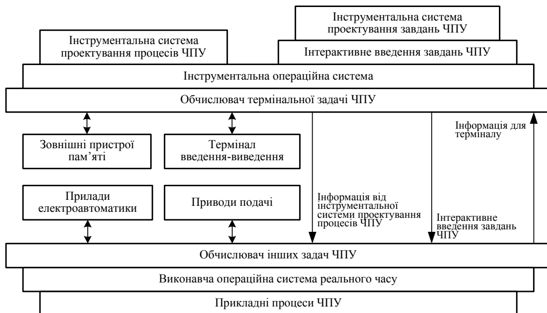
Рис. 6.46. Узагальнена структура реалізації термінальної задачі ЧПУ
