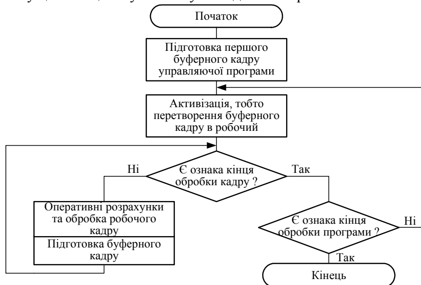
Рис. 6.8. Алгоритм роботи пристрою ЧПУ
